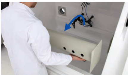
1. Das Sammelröhrchen im Luftsystem lässt sich leicht entnehmen.
