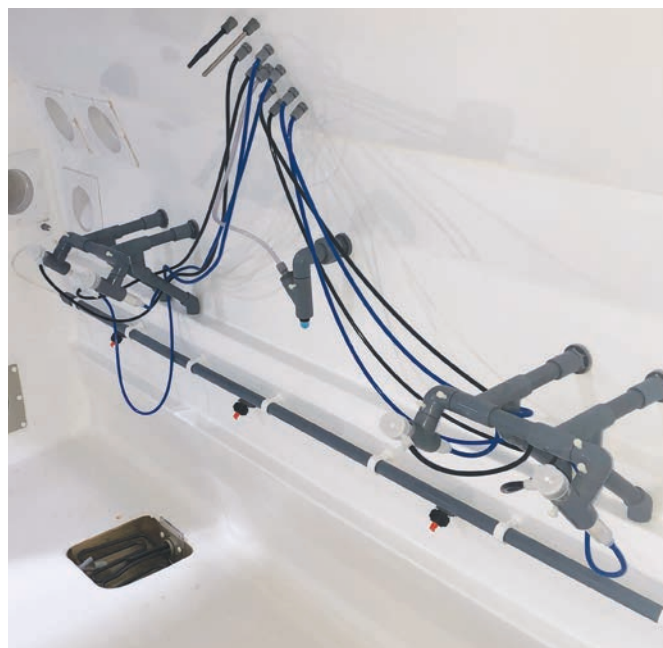
Beispiel für ein duales Zerstäubersystem an der 2600 l Atmosfär Premium-Kammer
