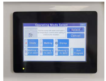
Automatisches SO 2 -Dosiersystem
