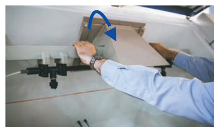
2. L'unité combinée de rampe de dispersion d'air et de rampe de pulvérisation oscillante est facile à soulever.
