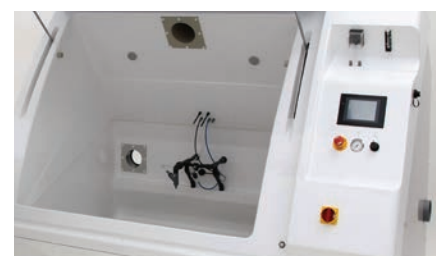
3. La chambre Atmosfär est désormais prête pour d'autres types d'essais de résistance à la corrosion.
