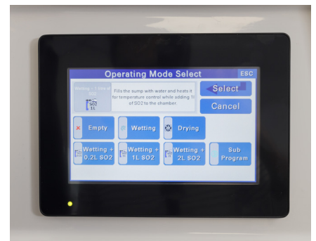
Automatisches SO 2 -Dosiersystem
