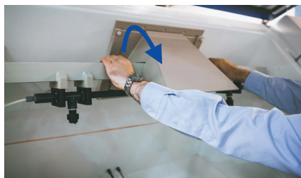
2. Die kombinierte Luftverteilungs- und Sprühstabeinheit lässt sich leicht herausheben.
