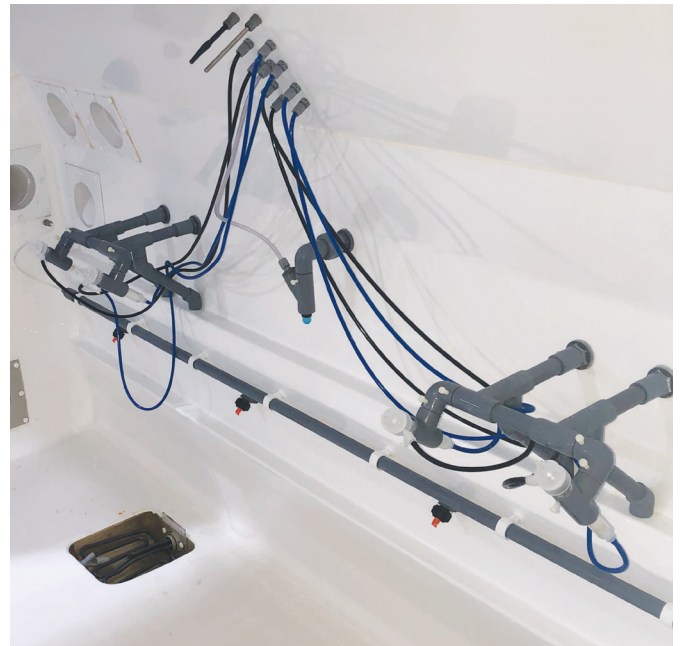
Beispiel für ein duales Zerstäubersystem an der 2600 l Atmosfär Premium-Kammer
