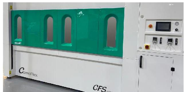
Ascott CorroFlex CFS480p+ Salzsprühkammer
