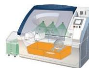
Diese Option besteht aus mehreren Sprühdüsen, die im oberen Bereiche einer zyklischen Kammer angeordnet sind und durch die Salzwasser direkt auf die Prüfstücke auf dem Prüfuntergrund gesprüht wird.
