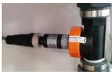
Diese Option besteht aus einem elektronischen Flüssigkeitsdurchflusssensor, der in der Kammer montiert ist und sich in der Leitung zwischen dem Salzlösungsbehälter und der Salzsprühdüse befindet. Der Sensor misst den Durchfluss der Salzlösung vom Vorratsbehälter zum Zerstäuber. Das Ausgangssignal des Sensors wird auf der HMI der Kammer digital als Momentanverbrauch in ml pro Minute und als Gesamtverbrauch in ml angezeigt.
