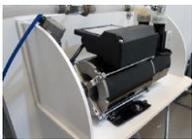
Eine außen angebrachte Wasserpumpe, die zur Erhöhung des vom Kunden eingespeisten Wasserdrucks verwendet werden kann. Wird typischerweise für das optionale Zubehör zur Reinigung der Wände eingesetzt, kann jedoch auch so angepasst werden, dass es zu anderen wasserspeisten Systemen passt.
