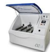
Zusätzliche Gebläsebaugruppe zur Unterstützung eines raschen Übergangs der Temperatur-/Feuchte-Prozesswerte von einem hohen auf ein niedriges Niveau, wie beispielsweise gemäß GMW3172.
