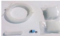
Ein Kit an Verbrauchsmaterialien/Verschleißteilen für eine Salzsprühkammer von Ascott. Die gelieferten Teile entsprechen dem Jahresbedarf an Verbrauchsmaterial.
