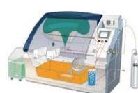
Eine SO<sub>2</sub>-Gasdosieranlage mit einem in der Kammer befestigten Dispersionsschlauch, durch den SO<sub>2</sub>-Gas mit einer über ein vom Bediener eingestelltes Steuerventil festgelegten Rate in die Kammerumgebung geleitet und mithilfe eines Durchflussmengenmessers überwacht werden kann.
