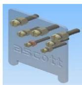
Eine Prüfplattenhalterung aus Polycarbonat, vorgebohrt mit 7 Löchern (3 x 6 mm, 2 x 5 mm, 2 x 4 mm), die mit Schrauben und Muttern versehen sind:
