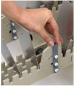
Diese Probenhalter verfügen über drei mit parallelen Schlitten versehenen Trägerschienen, die flexibel zusammengesteckt sind. Die äußeren beiden Schienen sind fest und die mittlere Schiene kann mithilfe eines Handhebels angepasst werden. Die innere Schiene kann so in Bezug zu den festen äußeren Schienen nach vorne und hinten bewegt werden.
