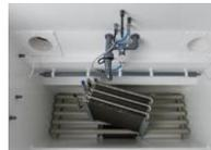
Herausnehmbarer Einlegeboden, der über dem Kammerboden eingelegt wird und eine horizontale Plattform zur Aufnahme großer/schwerer Proben bildet. Für Kammern unterschiedlicher Kapazitäten ist dieses Produkt in einer Vielzahl von Größen erhältlich.
