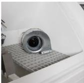
Gitterrost mit einer Maschengröße von 30 mm zur Prüfung von kleinen Bauteilen. Kann entweder auf den oberen oder unteren Trägern, mit denen die Kammer standardmäßig ausgerüstet ist, aufgelegt und bei Bedarf herausgenommen werden. Für Kammern unterschiedlicher Kapazitäten ist dieses Produkt in einer Vielzahl von Größen erhältlich.
