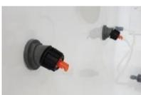
Diese Option besteht aus einem Wassersprühsystem, das für eine vom Benutzer einstellbare Anzahl von Minuten automatisch an programmierbaren Punkten innerhalb eines Korrosionstestzyklus die Wände mit Wasser abwäscht. Dies ist für einige Automobilstandards wie Renault D17
