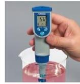
Tragbares, batteriebetriebenes digitales pH-Messgerät zur Messung des pH-Werts des Salznebel-Fallouts im Bereich von 0-14 mit einer Auflösung von 0,01 pH. Das Messgerät verfügt über einen manuellen Temperatureausgleich, Slope und Kalibriersteuerungen. Wird komplett mit Pufferlösungen zur Kalibrierung geliefert.
