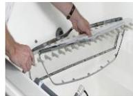
Herausnehmbare Probenaufhängung mit Sprossen. Verwendung zur Aufhängung von Proben an den Sprossen (10 mm/0,4" Durchmesser, 55 mm/2" lang), die in gleichmäßigem Abstand auf 2 gegenüberliegenden Seiten aus der Probenaufhängung herausragen.
