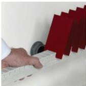
Abnehmbarer Probenhalter mit Schlitz für die Prüfung von Platten/Prüfstücken. Diese Probenhalter sind in verschiedenen Längen erhältlich, um verschiedenen Kammergrößen gerecht zu werden, und um den oberen und unteren Montagepositionen der Probenhalter in Standkammern zu entsprechen.
