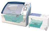
Programmgesteuert wird beheizte Immersionsflüssigkeit (normalerweise Salzwasser, das auf eine vom Benutzer einstellbare Temperatur von bis zu +50 °C/+122°F erhitzt wird) automatisch aus dem Vorrattank in die Kammer gepumpt und taucht die Prüfstücke ein.
