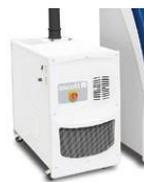
Diese Option bietet eine freistehende, luftumwälzende Entfeuchtungseinheit. Sie entnimmt der Hauptkammer Luft, die sie dann abkühlt oder aufheizt und entfeuchtet. Sie führt die Luft über korrosionsbeständige, isolierte, starre Ein- und Auslassanschlüsse in die Kammer zurück (separates optionales Zubehör ACC112/INT).
