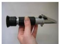
Ein Refraktometer misst den Brechungsindex, um die genaue Konzentration einer Substanz, die in einer anderen Substanz gelöst ist, zu bestimmen, beispielsweise die 5-prozentige Konzentration von Salz (Natriumchlorid) in Wasser, die in den meisten Salzsprühprüfnormen vorgeschrieben ist.
