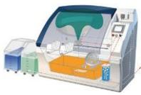
Diese Option bietet eine zweite Lösungsleitung, ein unabhängiges Pump- und Fördersystem und einen zusätzlichen Tank.
