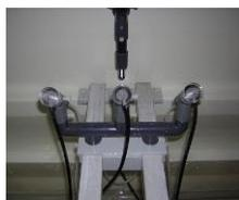
Diese Ausstattung ermöglicht dem Nutzer einer Ascott CCT-Kammer die Herstellung von Salzsprühklimabedingungen aus bis zu 3 verschiedenen Salzlösungen.
