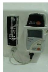
Ein batteriebetriebener Mini-Datalogger, der kontinuierlich über einen angeschlossenen Temperaturfühler die Lufttemperatur (Grad Celsius) in der Kammer misst.
