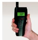
Ein separater, freistehender, batteriebetriebener Datalogger, der über ein 2 m langes Verlängerungskabel an ein Fernmessgerät zur Feuchte- und Temperaturmessung angeschlossen ist. Der Datalogger zeichnet kontinuierlich die vom Messfühler festgestellte Temperatur und Feuchte für bis zu 5000 Proben unterschiedlicher Werte auf; der Bediener kann ein Messintervall von 15 s bis 2 h programmieren. Es kann ein Temperatur- und Feuchtebereich von -40 bis +85 °C und 0 bis 100 % RH aufgezeichnet werden.
