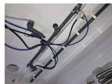
Zusätzliche(r) Salzsprühnebelzerstäuber und zugehörige Pumpe(n), die in die Kammer eingebaut werden, um höhere Fallout-Raten von 2,0 bis 5,5 ml/80 cm<sup>2</sup>/Stunde
