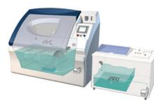
Programmgesteuert wird beheizte Immersionsflüssigkeit (normalerweise Salzwasser, das auf eine vom Benutzer einstellbare Temperatur
