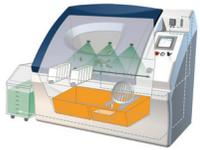
Diese Option besteht aus mehreren Sprühdüsen, die auf hoher Ebene in einer zyklischen Kammer angeordnet sind und durch die Salzwasser direkt auf
