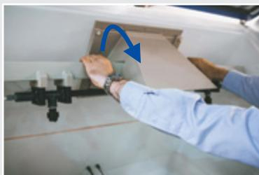
2 组合式空气扩散器和摆动喷杆单元可以容易地提起拆卸。
