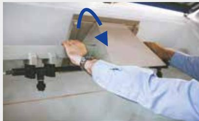
**2** Die Kombination aus Luftzuführung und oszillierende Sprühhvorrichtung kann sehr einfach ausgehängen werden.
