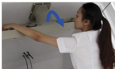
**2** Kombinierte Luftverteilungsvorrichtung und schwingender Düsenstock lassen sich einfach herausheben.
