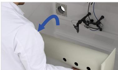
**1** Leicht zu entfernende Luftabsaugung.
